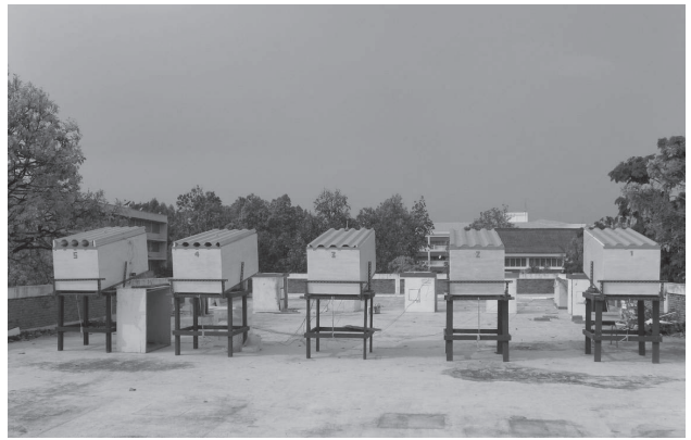
ภาพที่ 3 การทดลองของหลังคาเหล็กกรีดทั้ง 5 แบบ ที่มุมเอียง 10 องศา หันไปทางทิศใต้ บนดาดฟ้าอาคารสูง 4 ชั้น คณะสถาปัตยกรรมศาสตร์ มหาวิทยาลัยขอนแก่น วันที่ 19-21 และ 28.02.10
