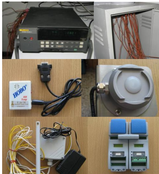
ภาพที่ 1 แสดงเครื่องมือวัดและบันทึกอุณหภูมิ, ความชื้น, รังสีอาทิตย์, และความเร็วลม ตามลำดับจากบนลงล่าง
