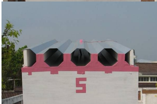
ภาพที่ 2 รูปตัดกล่องทดลองของหลังคาเหล็กรีดทั้ง 5 แบบ เรียงจากบนลงล่างตามลำดับ และแสดงจุดตรวจวัดที่ตำแหน่งต่างๆ
